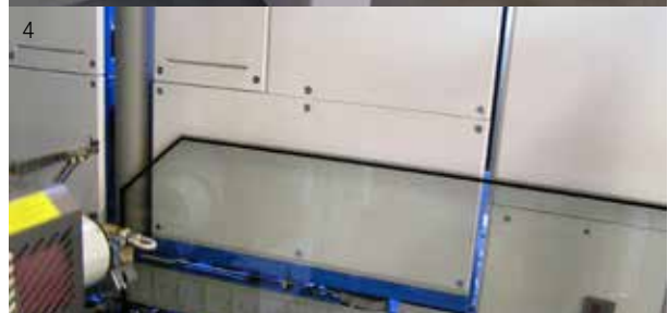
Bild 3: Scheibe mit TPS-Strang vor dem Zusammenbau
